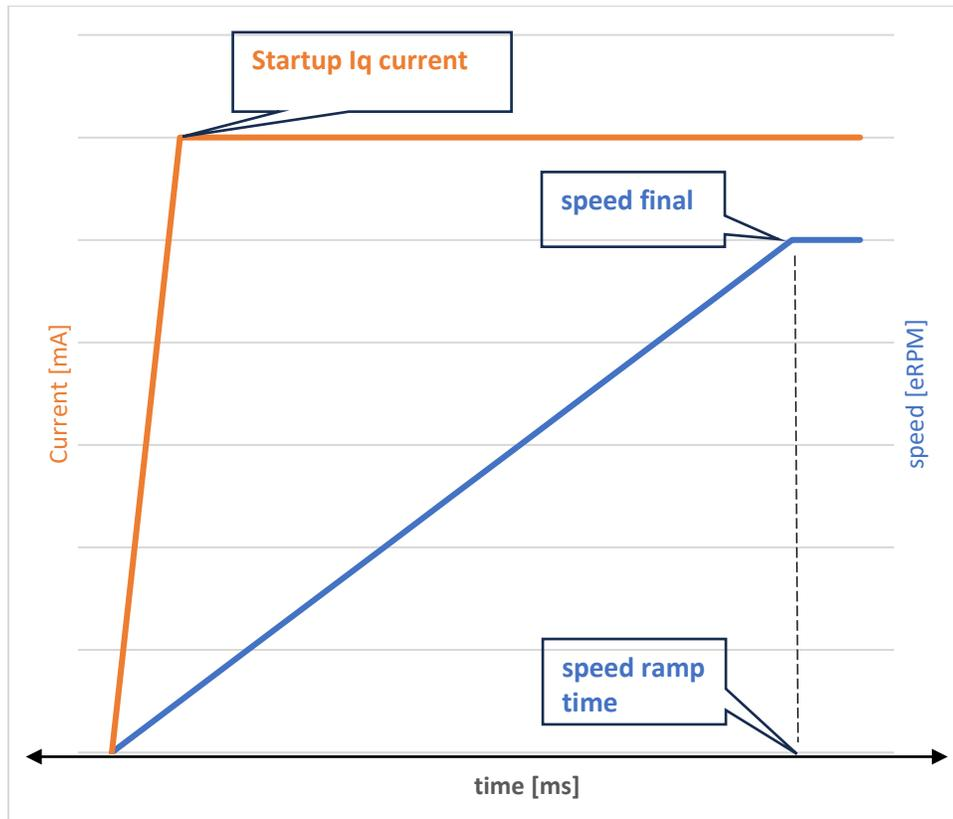
Figure 3 I/F startup parameters
